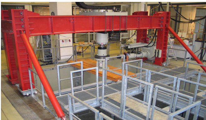
Bild 1: Teilansicht der Versuchsgrube mit Portal und Belastungseinrichtung
